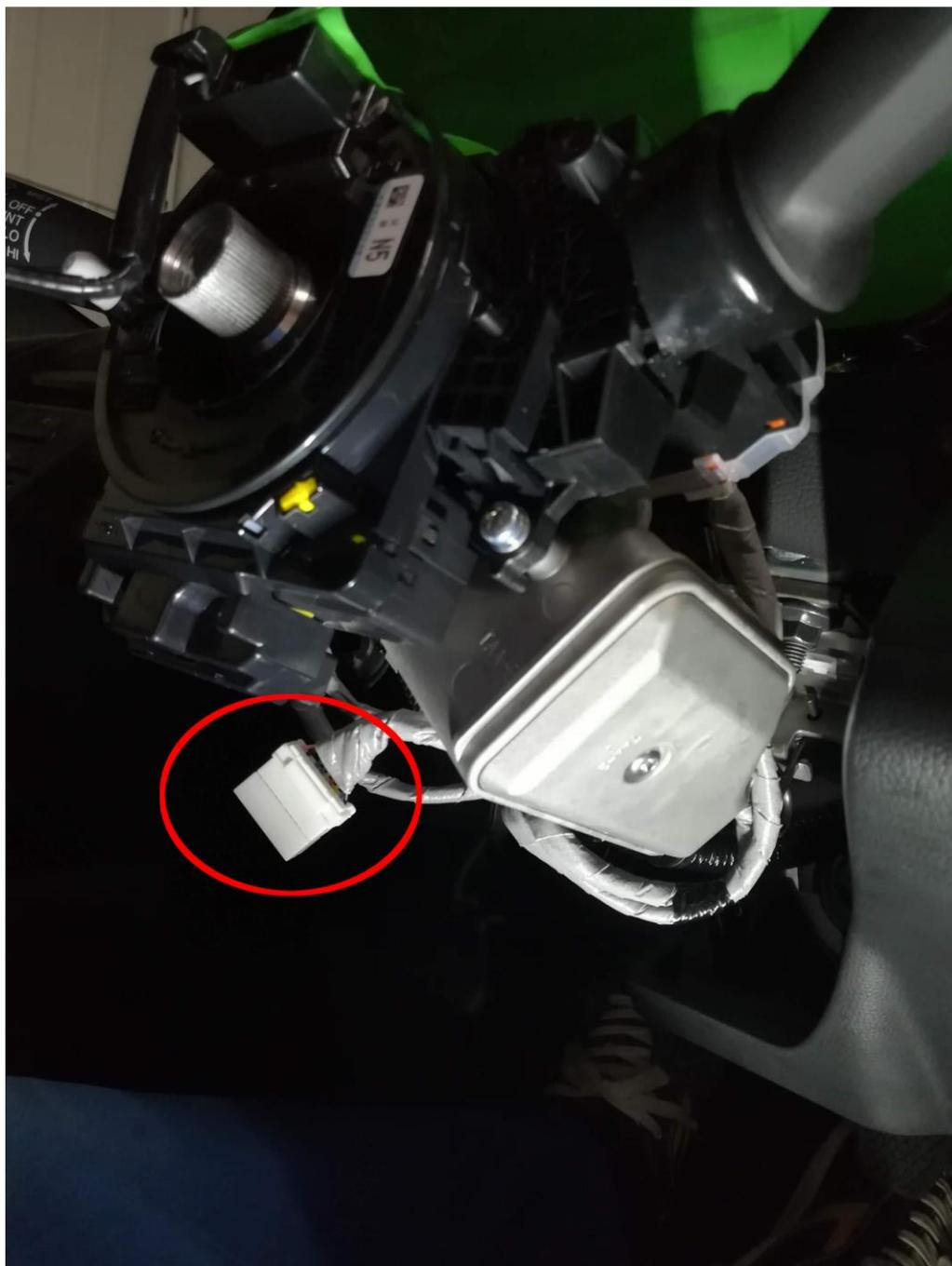
②ケーブルリールに S660 ステアリングスイッチ移設ハーネスの 20 ピンメスコネクタを接続します。
